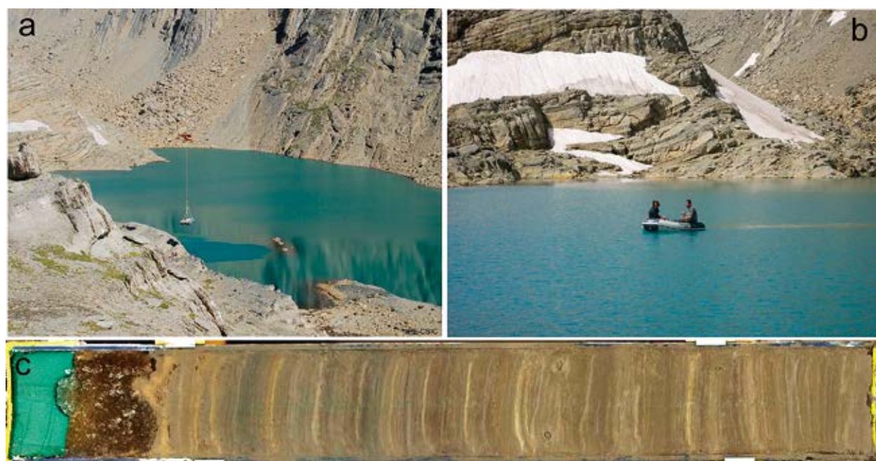
a) Helicóptero trasladando la plataforma para extraer los sondeos lacustres en el ibón de Marboré - b) Trabajando en el ibón de Marboré - c) Una de las secciones del registro lacustre de Marboré
